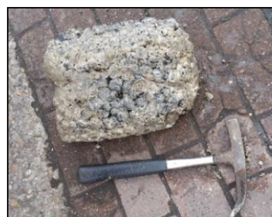
Désobstruction et bloc de graisse provenant du réseau récupéré après curage
